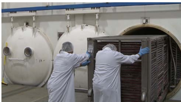
Placées dans un système de réfrigération sous vide, les matières premières congelées sont déshydratées sans décongélation. Ainsi, la glace contenue dans le produit est sublimée en vapeur.
