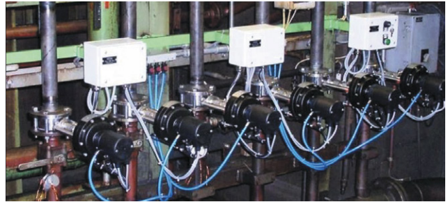
Gleitschieberventile regeln den Durchfluss in Aluminium-Walzwerk: die aggressive und abrasive Walzemulsion ist für diese Ventile mit der Funktionseinheit aus zwei gegeneinander dichtenden Schlitzscheiben kein Problem. Hohe Dichtheit trotz Partikelfracht, lange Standzeiten und kurze Schaltzyklen bilden beste Voraussetzungen für wirtschaftliche Produktionsbedingungen.
