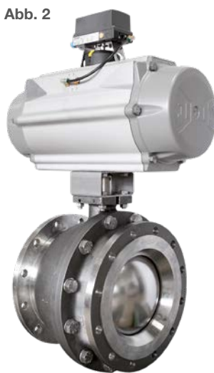
Abb. 2 Kugelsektorventile der Baureihe 4040 sind in den Nennweiten DN 25 bis DN 300 lieferbar. Bis Nennweite DN 250 sind die Ventile in Zwischenflanschausführung (in DN 300 mit Flansch) konstruiert. Die verfügbaren Druckstufen sind PN 16 bis PN 40 (ANSI 150 bis ANSI 300). In Abhängigkeit von der Nennweite sind K_{vs} -Werte von 1,45 bis 3.840 möglich. Diese Kugelsektorventile werden in Edelstahl 1.4408 hergestellt. Je nach gewähltem Dichtungswerkstoff können die Kugelsektorventile bis 220 °C eingesetzt werden.
