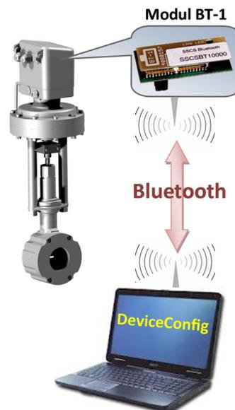
Schematische Darstellung der Verbindung zwischen digitalem Stellungsregler 8049 und der Konfigurationssoftware mit dem Bluetooth-Modul BT-1.
