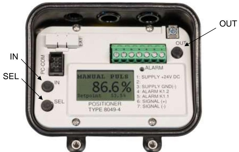
Durch Drücken der Tasten "IN" (Zuluft in den Antrieb) bzw. "OUT" (Antrieb wird entlüftet) wird das Ventil auf bzw. zu bewegt. Wird keine Taste betätigt, schließt der Stellungsregler die Luft im Antrieb ein.
